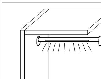
Die beleuchtete Kleider- und Eckkleiderstange (Legno, Uno) enthält ein LED-Band, das in der Breite millimetergenau anpassbar ist und sich mit allen Schalterlösungen kombinieren lässt. Die Befestigung geschieht unter einem Einlegeboden. Die Kleiderstangen sind in Silber eloxiert oder Dunkelbronze erhältlich. Die Kleiderstange für Ecoline ist abweichend.
