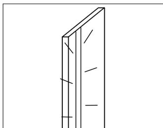
Die Position des Beleuchtungsprofils mit innenliegendem LED Band (4,8W/m; 3.700K) ist auswählbar. Es kann entweder im vorderen Bereich oder im hinteren Bereich der Schrankseite eingesetzt werden. Das Beleuchtungsprofil ist immer auf die Länge der Schrankseite abgestimmt. Soll beidseitig ein Beleuchtungsprofil eingelassen werden, so wird das zweite Beleuchtungsprofil versetzt flächenbündig eingelassen. Die LED Seitenbeleuchtung kann mit verschiedenen Schaltern kombiniert werden.
