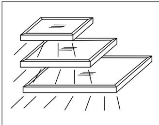
Im Alurahmen Glasboden ist ein LED-Band integriert. Dieses sitzt im vorderen Bereich und gibt indirektes Licht nach hinten ab. Die Glasscheibe ESG liegt lose im Rahmen auf.
