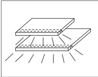
Die beleuchteten Einlegeböden und Eckböden haben ein innenliegendes LED-Band im Fachboden flächenbündig eingelassen und sind in der Breite, wie die Böden, flexibel. Die Beleuchtung kann mit verschiedenen Schaltern kombiniert werden.
